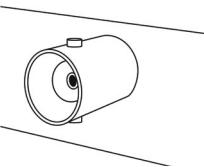
位于设备前部的输入信号 BNC 连接器
