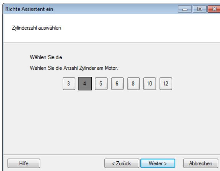
Auf diesem Bildschirm müssen Sie die Anzahl der Zylinder des zu testenden Fahrzeugs angeben.
