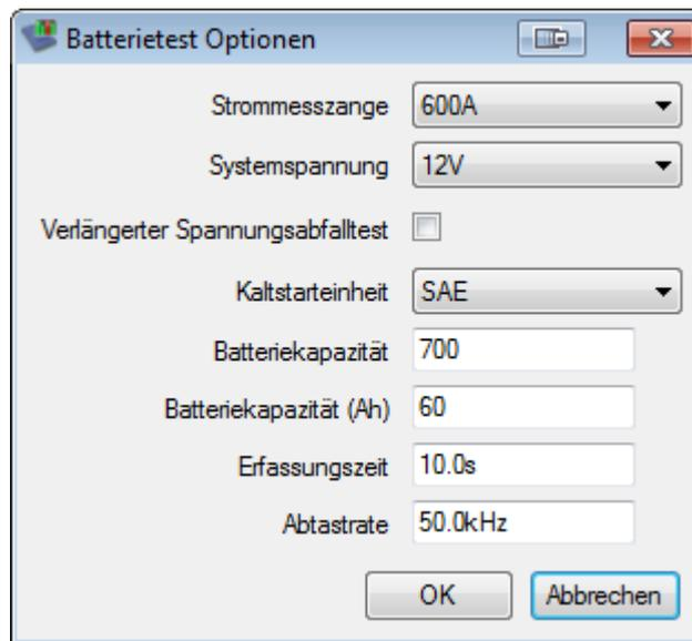
Batteriekapazität (CCA): Die Batteriekapazität als Kaltstartstrom in Ampere.
