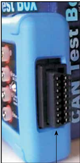
16-poliger Durchleitungssteckeranschluss der CTB
