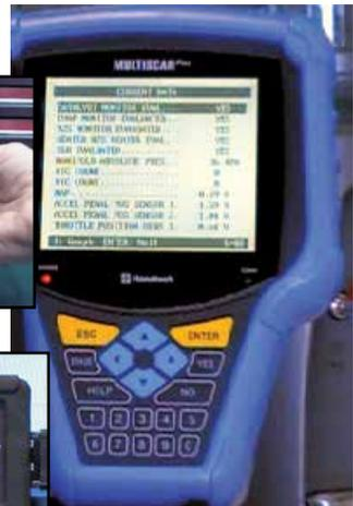
Schließen Sie die CTB und das Diagnosegerät an und überwachen Sie gleichzeitig die LEDs der CTB sowie die Daten des Diagnosegeräts.
