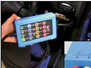
CTB ist an DLC-Anschluss des Fahrzeugs angeschlossen
