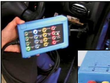
CTB ist an DLC-Anschluss des Fahrzeugs angeschlossen
