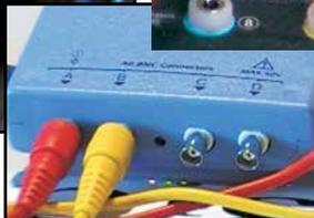
Oszilloskop-Anschluss der CTB-Messfühlerleitung (BNC)
